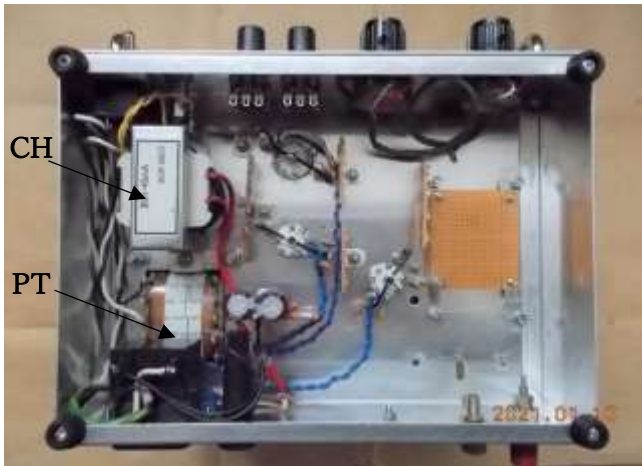
Fig.5-1 一次側・ヒータ配線 (青線)
