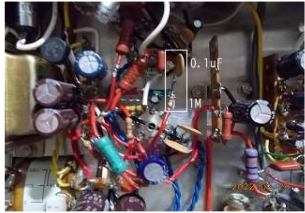
Fig.4-7 1MΩ-0.1 μF フィードバック部
